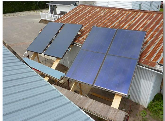
Figure 2b – Capteurs solaire thermique sur le banc d'essai
